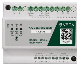
風機盤管執行器用於中央水空調的控制，風機三速控制。採用導軌式安裝，外接高精度數位式溫度感測器，支援兩管制、四管制的風機盤管。
